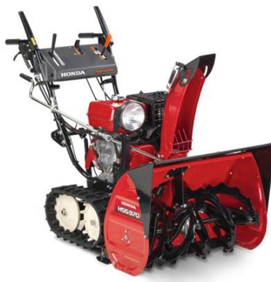
Cingoli, fresa da 71 cm e meccanismo di regolazione dell'altezza della fresa, consente di spostare fino a 50 tonnellate di neve all'ora.
