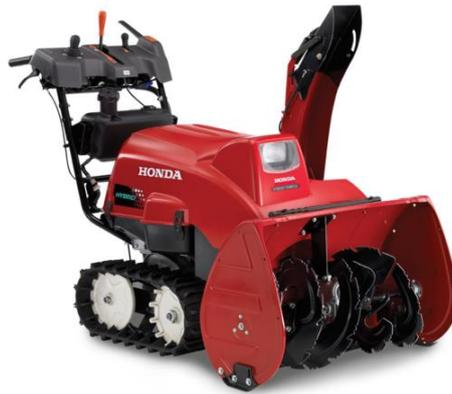
Cingoli, fresa da 81 cm e meccanismo di regolazione dell'altezza della fresa, consente di spostare fino a 65 tonnellate di neve all'ora.
