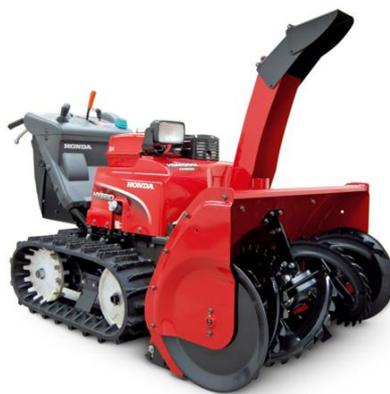
Cingoli Zero Turn, fresa da 92 cm, meccanismo di sollevamento della fresa tramite joystick e meccanismo di ripristino, consente di spostare fino a 83 tonnellate di neve all'ora.
