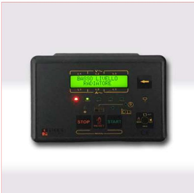
Centralina per quadro manuale o semi-automatico (start da contatto remoto) di controllo di un gruppo elettrogeno, con strumenti digitali, segnalazioni ed allarmi su display LCD in varie lingue, dotata di CAN BUS (SAE J1939) e con diverse connessioni seriali per controllo remoto.
