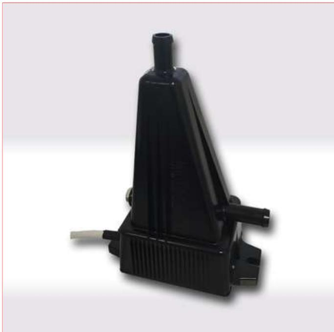
Riscaldatori da 500W, 1000W, 1500W che impediscono che la temperatura del circuito di raffreddamento scenda al di sotto di un certo valore. Tale valore è regolato da un termostato interno. Realizzati in un solido corpo di alluminio verniciato a cataforesi che lo rende resistente ai componenti chimici del liquido di raffreddamento. La circolazione dell'acqua, avviene con il principio del termosifone. Dotati di connessione con "portagomma".
