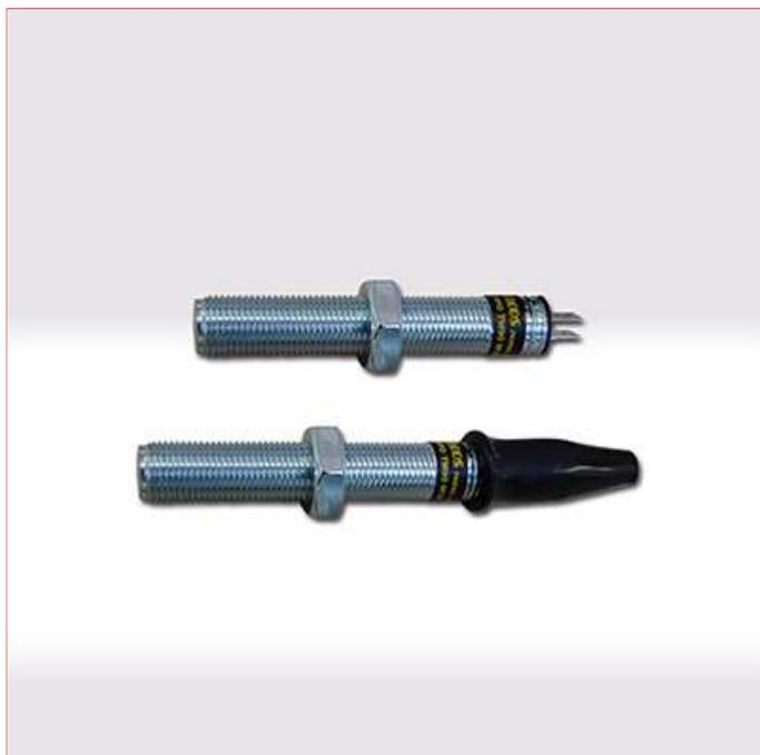
Pick-ups che erogano un segnale di tensione a frequenza proporzionale alla velocità della corona dentata. Funziona a variazione di riluttanza con segnale d'uscita a forma sinusoidale.
